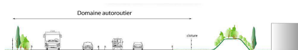
Retrait entre construction et autoroute traité par une bande plantée
